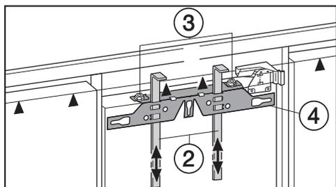
■ Отверните гайки ③ и снимите крепёжную планку ④ вместе с упорами ②.
