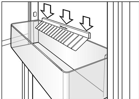
Пластинки над полкой для бутылок лучше удерживают их при открывании и закрывании дверцы прибора.
