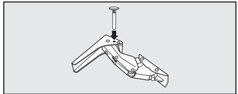
■ Вставьте прилагаемые штифты для ограничения угла открывания дверцы в петли сверху.
