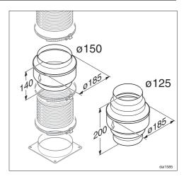
Neben der Isolation der Abluftleitung empfehlen wir die Installation einer Kondenswassersperre, die das Kondenswasser aufnimmt und verdunstet.
