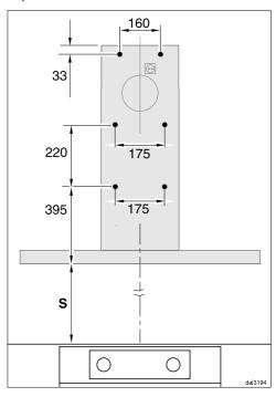
■ Wird vorab eine Rückwand angefertigt, die schon über die Befestigungslöcher verfügen soll, sind hier die Abstandsmaße der Bohrungen angegeben (Schrauben Ø 5 mm).
