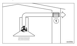
Bei Abluftbetrieb dämpft der Schalldämpfer sowohl Gebläsegeräusche nach außen als auch Außengeräusche, die über die Abluftleitung in die Küche dringen (z. B. Straßenlärm). Dazu wird der Schalldämpfer möglichst nah vor dem Abluftaustritt ① positioniert.
