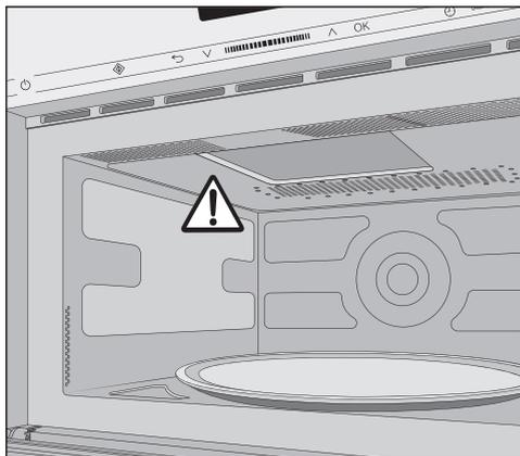
Не удаляйте специальную защитную пластину, расположенную в рабочей камере перед отверстием выхода микроволн.
