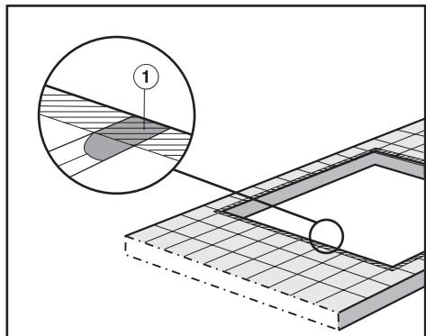
Герметик ни в коем случае не должен попадать между рамкой верхней части прибора и столешницей!
