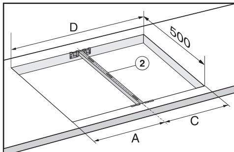
При встраивании **двух приборов** ширина выреза в столешнице D получается из размеров А и С.
