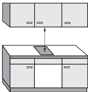
Между прибором и расположенной над ним вытяжкой должно быть соблюдено безопасное расстояние в соответствии с указаниями производителя. При отсутствии данных, например, для подвесной полки, это расстояние должно составлять для легковоспламеняемых материалов мин. 760 мм.
