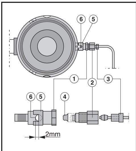
④Пластиинка форсунки (Главная форсунка для внутренней горелки)
